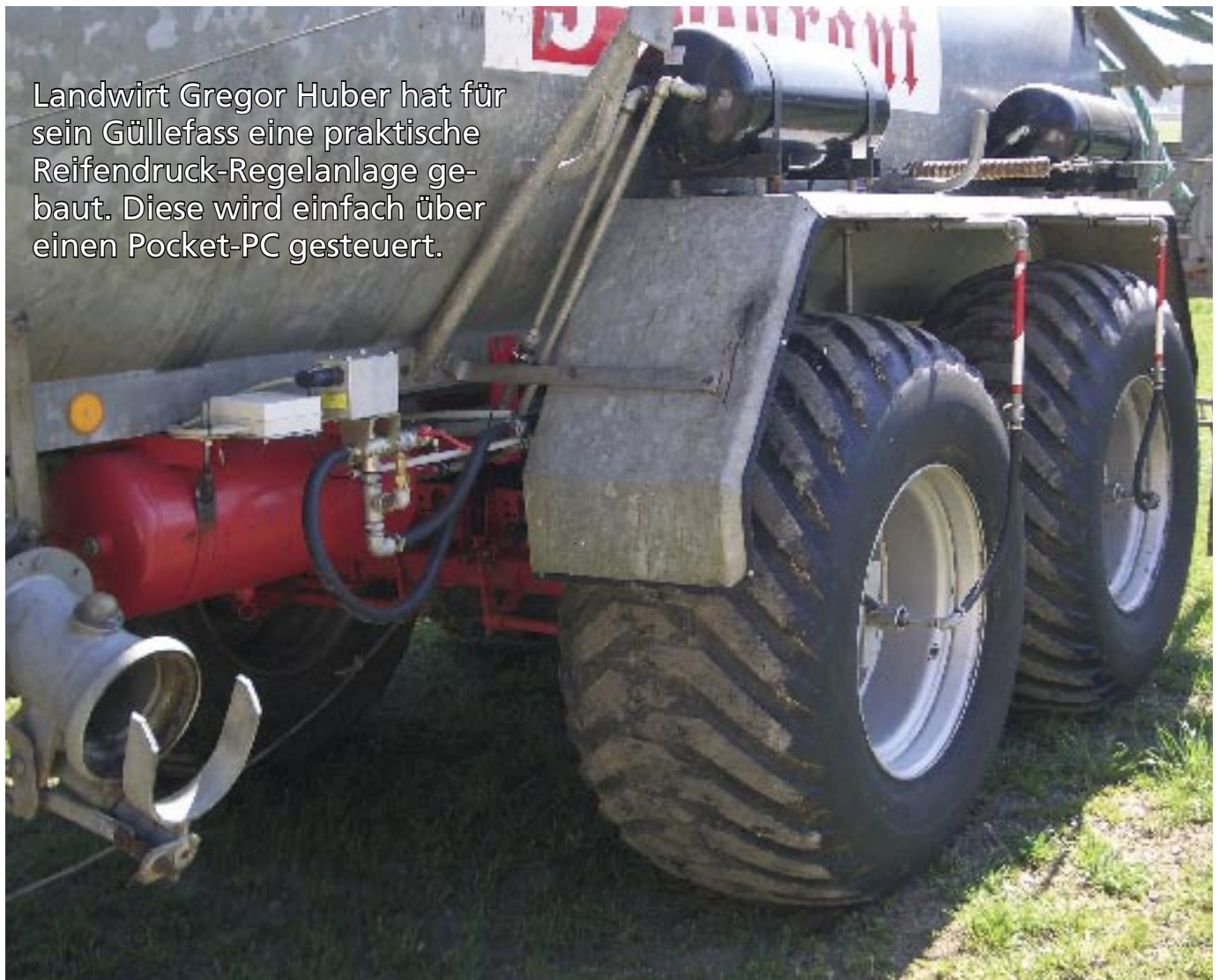
Die Hauptbestandteile der Regelanlage am Güllefass sind Steuerungsbox, Dreiwegeventil und Vorratsbehälter sowie ein Drehübertrager. Fotos: Huber, Gerl
